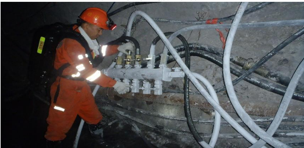
图 4 救援人员正在操作“气（液）路分流控制器”实施液态二氧化碳灌注
