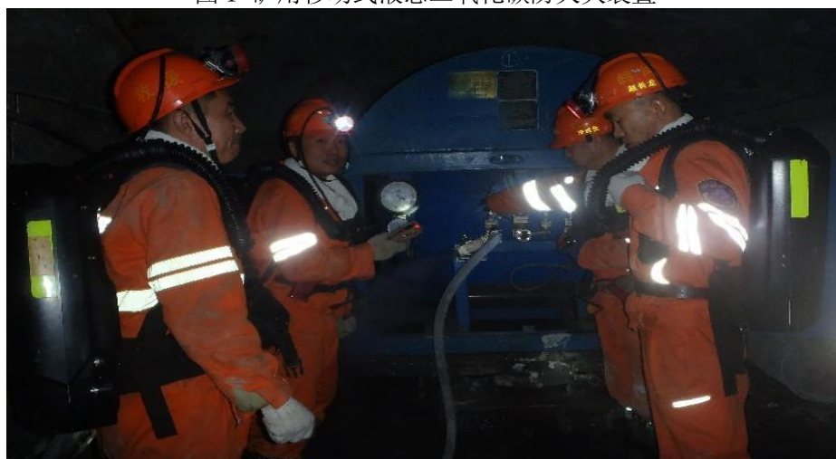
图 2 灌注液态二氧化碳治理发火隐患现场
