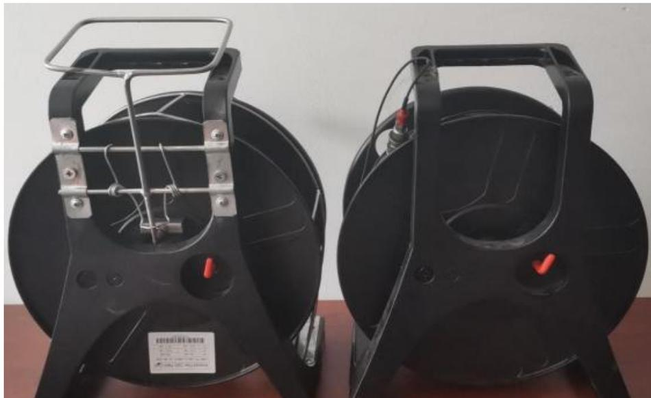
图 1 刹车、导线槽及防飞线保护装置改造前后对比
