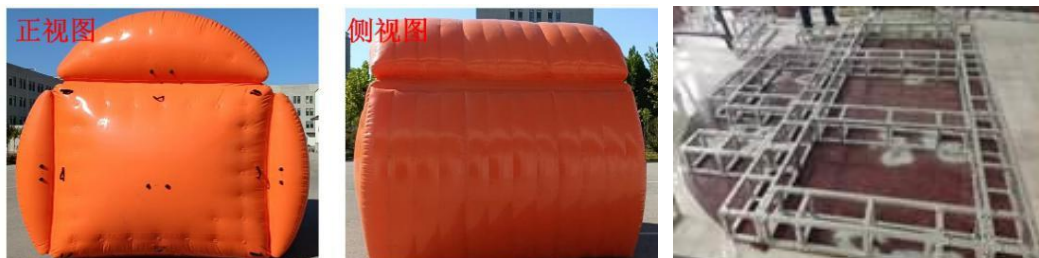
气囊与桁架构筑物实物图
