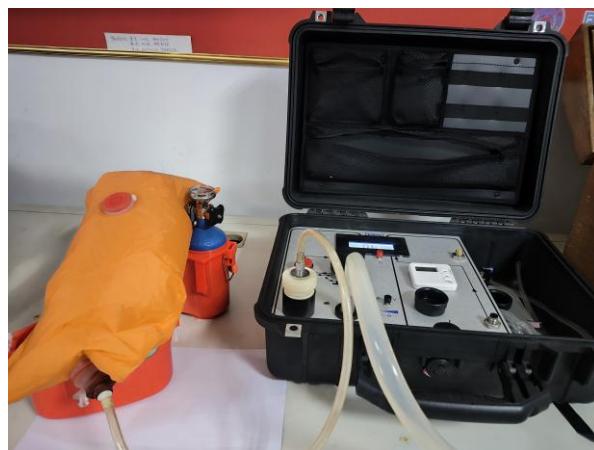
图 4 压缩氧自救器校验
