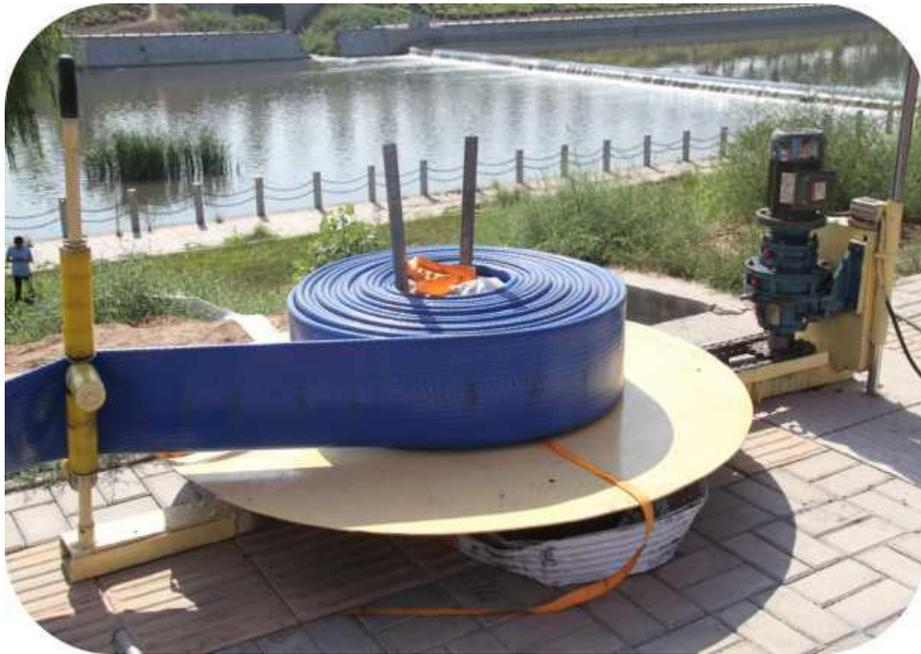
图 2 一代高压排水软自动盘卷机
