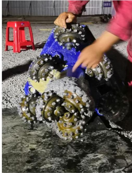
图 3 导向换成中心钻孔的三牙轮钻头
