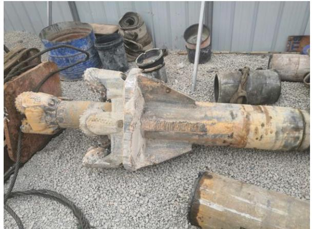
图 5 导向钻头加装裙板（防止导向钻头被卡）
