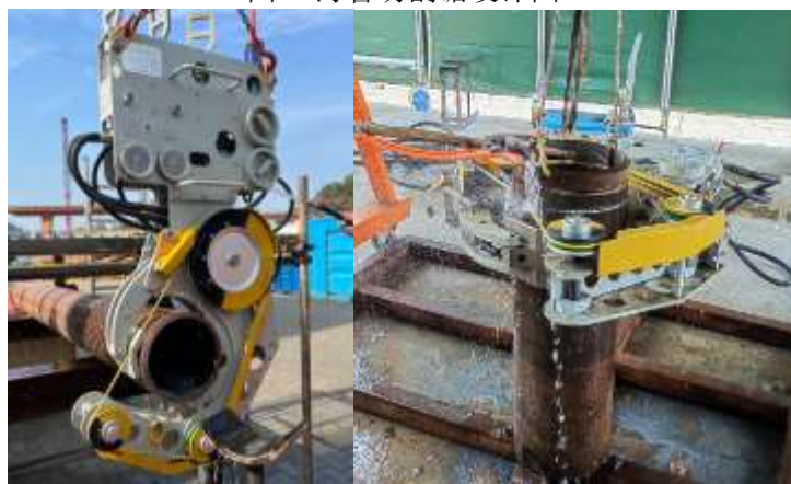
图 2 海管切割锯实物图
