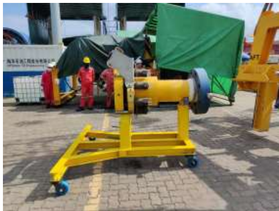
图 1 海管机械连接器在安装框架上
