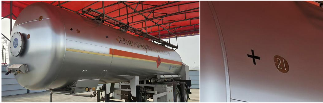
图 1-14 罐体泄漏部位示意图
