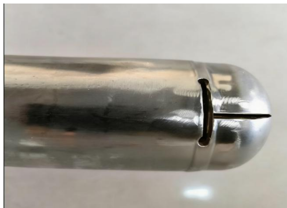
图 1-15 输油管路泄漏部位示意图
